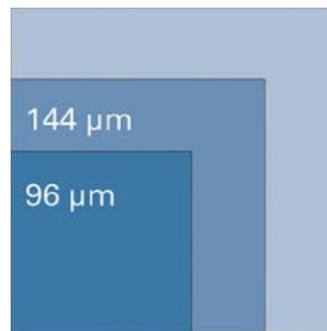
Mode Fine High Speed : taille de pixel 144 µm Mode Super Fine : taille de pixel 96 µm
